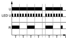
Включение напряжения питания U, инициирует циклическую работу с включения исполнительного реле R на установленное время T. После отсчета времени T, исполнительное реле R отключается на время T. Циклическая работа длится до момента выключения питания U.
